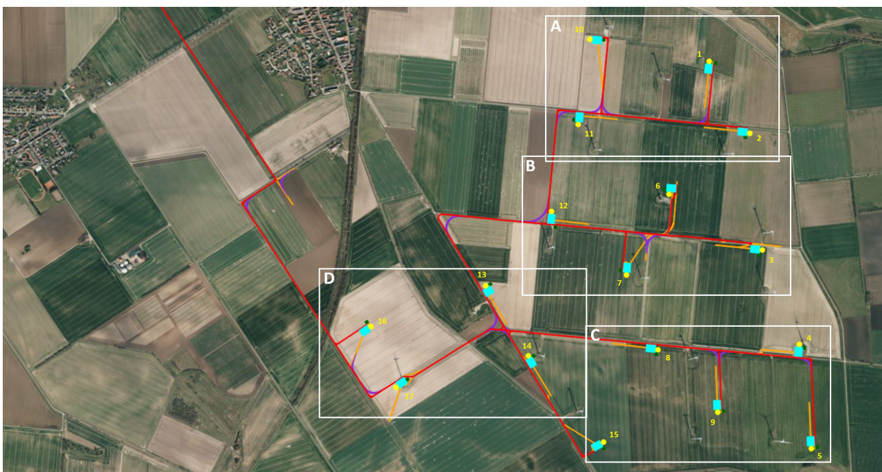
Abbildung 6: Lage und Planung der 17 Windenergieanlagen zusammengefasst in vier Gruppen (A-D, vgl. Abb. 7-10) jeweils mit Fundament (gelb), Kranstellfläche (hellblau) und Zuwegung (rot) sowie der temporär beanspruchten Flächen (grün: Montagefläche; lila: Kurvenausbau Rotortransport, orange: temporäre Zuwegungen) - Planungsstand: 09/2021 - Quelle: Landwind Planung GmbH (2021)
