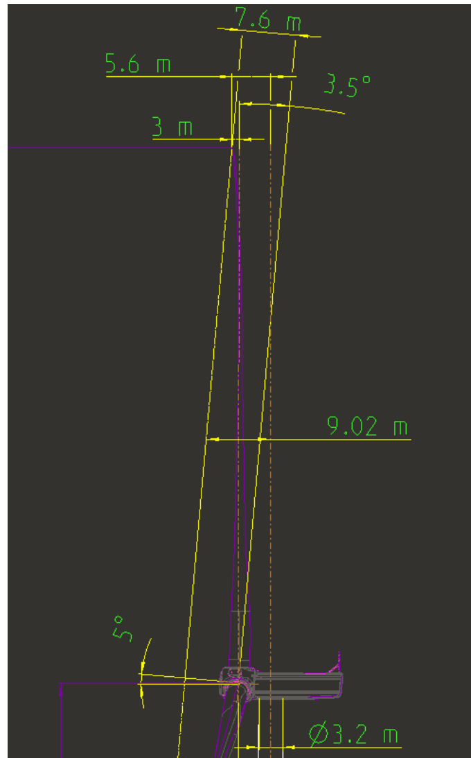
Abbildung 2: Exzentrizität von 9,02 m im Abstandspunkt P_m(0,5H)
